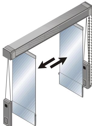
**4** Sistem realizat cu deschidere asimetrica (sau identica) cu strangere spre margini.
