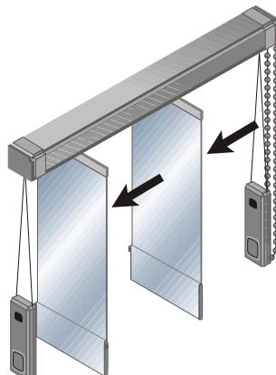
**5** Sistem realizat cu deschidere asimetrica (sau identica) cu strangere de aceeasi parte.
