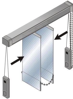
**6** Sistem realizat cu deschidere asimetrice (sau identica) cu strangere in mijloc.
