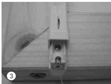
3. Fixare fir nylon in sistem de prindere de plastic
